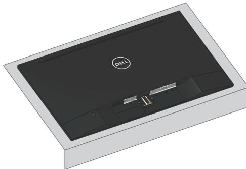
2. Richten Sie die Ständerhalterung mit der Rille am Monitor aus.
